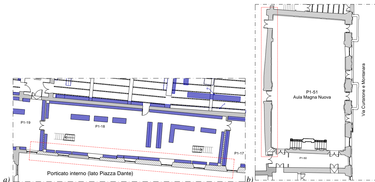
Figura 11.14: Assenza di elementi di ritegno verso le azioni dinamiche fuori piano per la parete longitudinale del porticato parallelo a Piazza Dante (piano primo).
