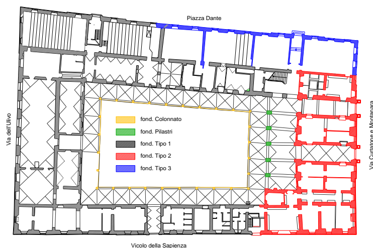
Figura 10.15: Suddivisione in pianta della struttura in funzione delle caratteristiche del complesso fondazione - terreno.
