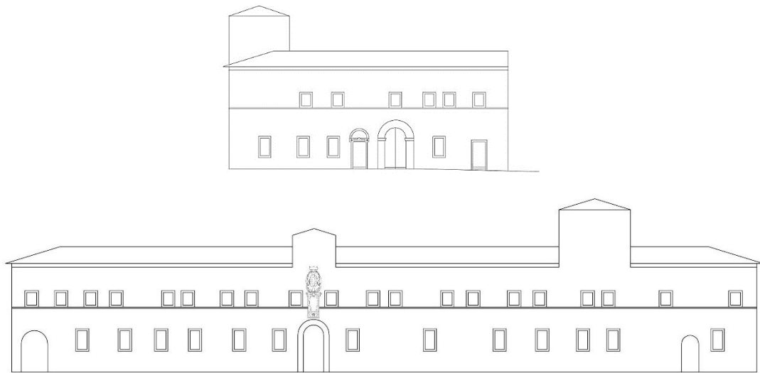
Figura 3.24: Ricostruzione ipotetica dell'articolazione delle facciate nel periodo mediceo a) ad est (presso la via Curtatone e Montanara); b) a sud (presso la via della Sapienza)
