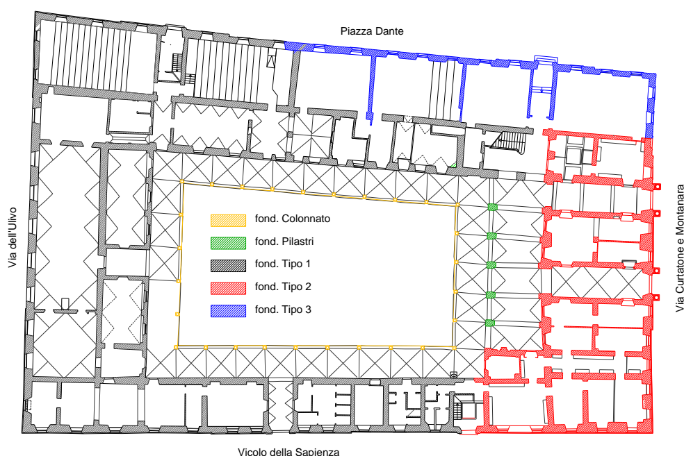
Figura 10.5: Schematizzazione tipologia di fondazione e applicazione al modello.
