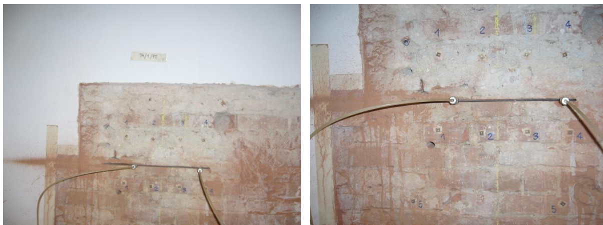
Prova con martinetti piatti singoli.
