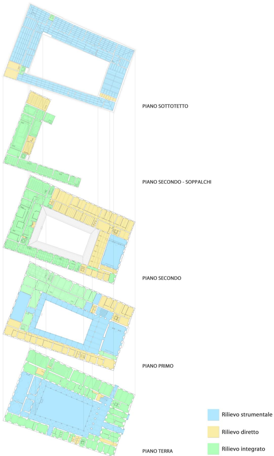
Figura 4.1: Schema assonometrico di ogni livello dell'edificio, con in evidenza la metodologia di rilievo adottata: rilievo strumentale (celeste), rilievo tradizionale diretto (giallo), rilievo integrato strumentale-diretto (verde).
