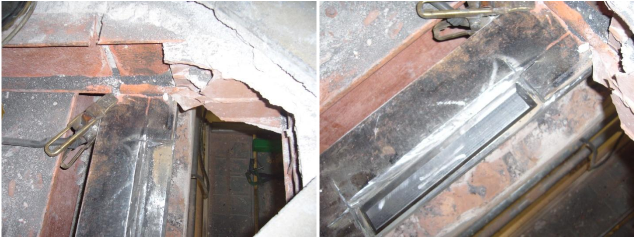
Figura 8.16: Dettagli del prelievo del campione dal profilo IPN400 dell'orditura principale.
