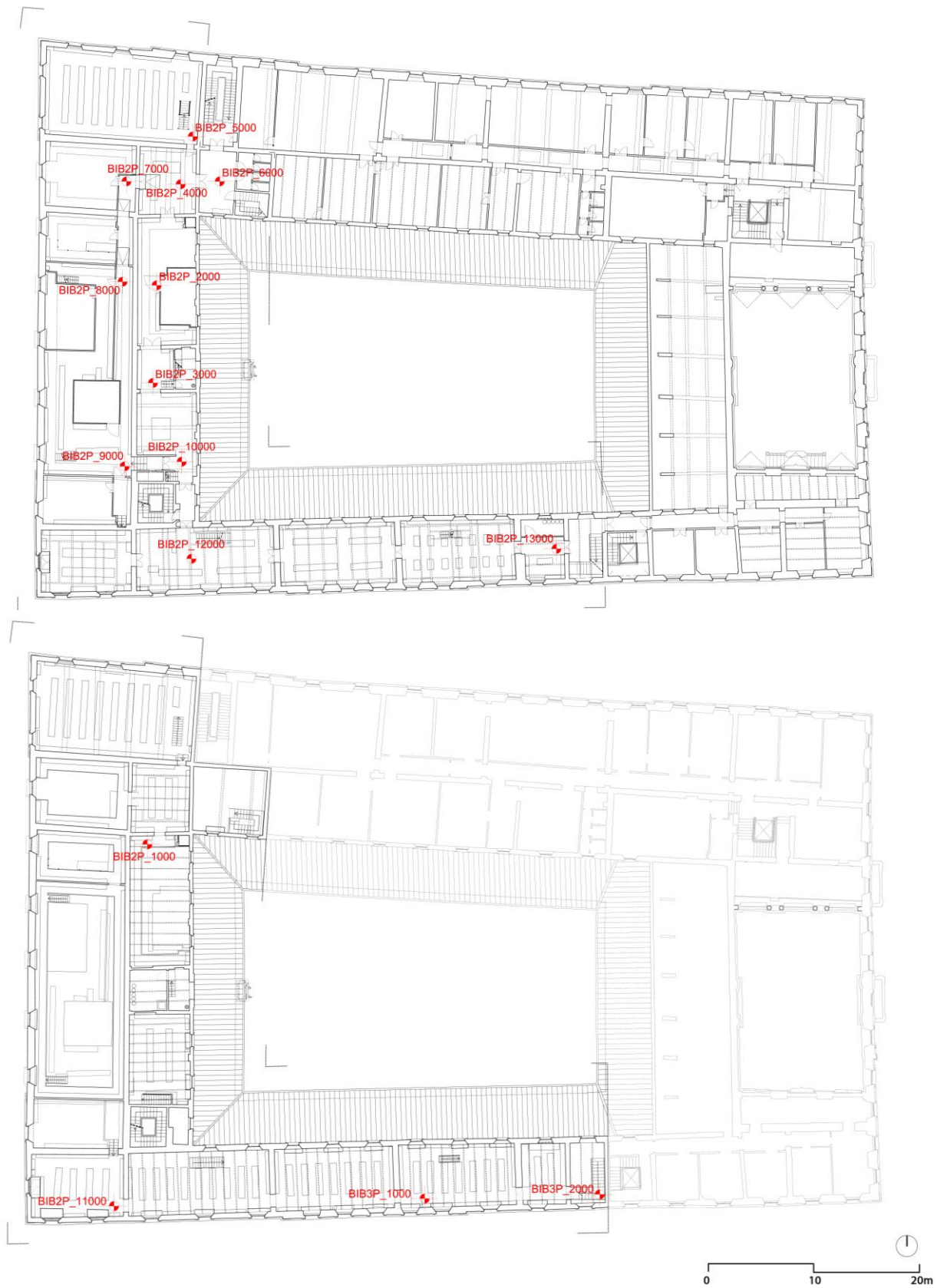
Figura 4.4: Pianta del piano secondo - in alto - e del livello soppalco al piano - in basso - con in evidenza i capisaldi dei rami di poligonale ai due livelli.
